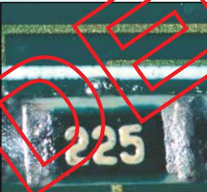
Jegliche Kugeln aus Lot, die nicht in einer Schutzschicht eingeschlossen sind, nicht mit einem metallischen Kontakt verbunden sind oder den elektrischen Mindestisolationsabstand verletzen.
