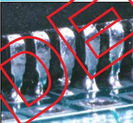
Ein oder mehrere Bauteilanschlüsse sind verbogen (schlechte Koplplanarität), wodurch die Bildung einer ordentlichen Lötstelle verhindert wird.
