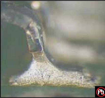
Bleifreie Lötstellen haben typischerweise ein körniges oder mattes Aussehen, sowie größere Benetzungskontaktwinkel.
